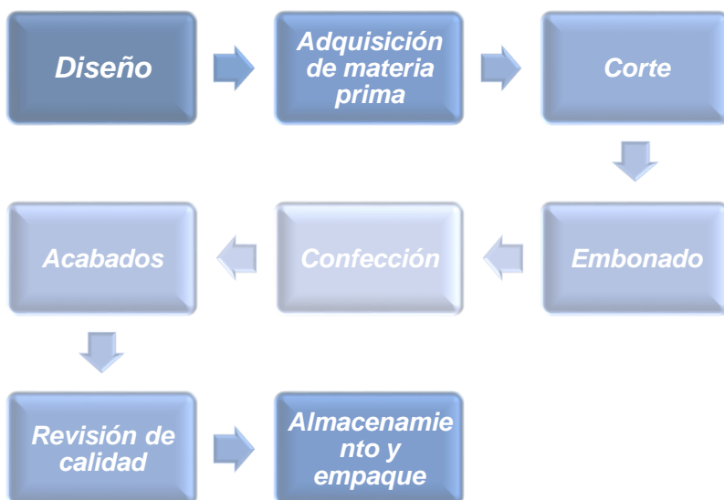
Ilustración 9: Flujograma de proceso de producción
