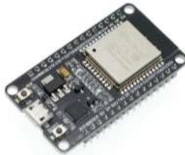
**Figura 33. Tarjeta Desarrollo Esp32 Driver CP2102 Iot Wifi Bluetooth Arduino.**
