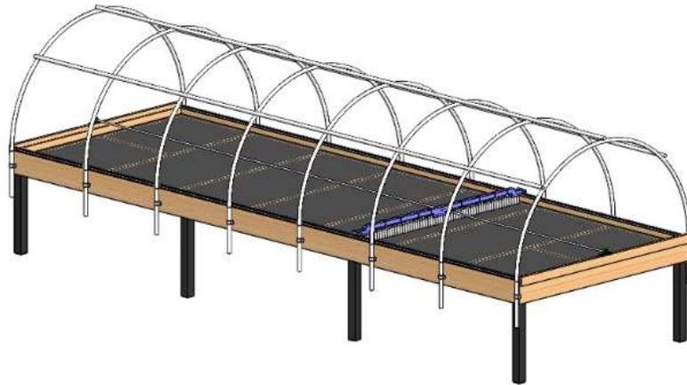
**Figura 14. Modelo 3D del Secador Parabólico.**
