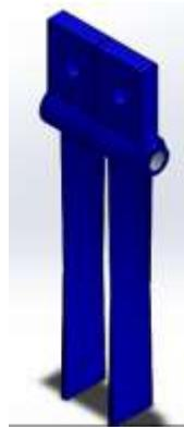
**Figura 16. Primera versión de las aspas para el sistema de mezclado.**
