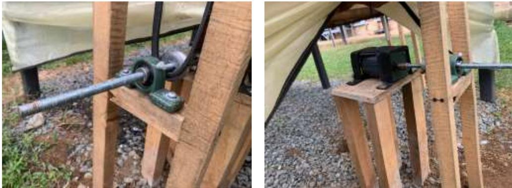
**Figura 44. Soporte para eje que conecta al motor.**
