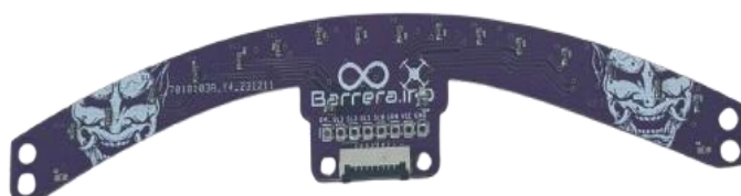
Ilustración 12. Sensor XL 16 Barrera.ino, Fuente: Elaboración propia
