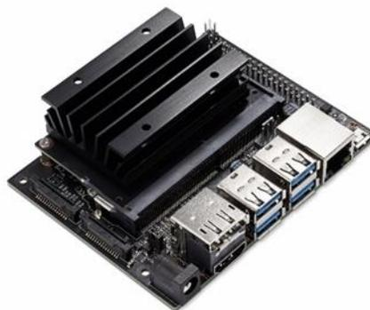
*Fig. 14 Tarjeta Jetson Nano. Fuente: [20]*
