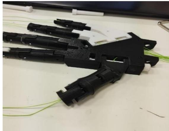
Figura 28. Ensamblaje de mano robótica. Fuente: Autor.
