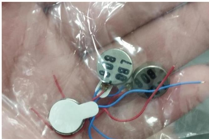
Figura 43. Micromotor de vibración 1030 DC utilizados en el sistema de retroalimentación. Fuente: Autor.
