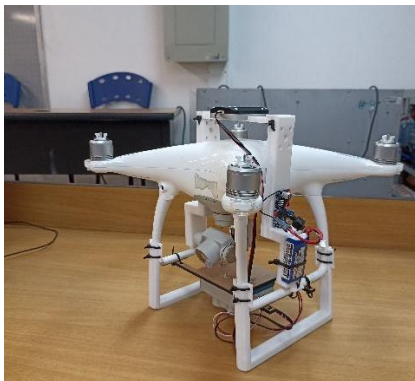
Figura 33 Instalación circuito de alimentación para cámara Micasense RedEdge Mx Blue al drone. Fuente autor.
