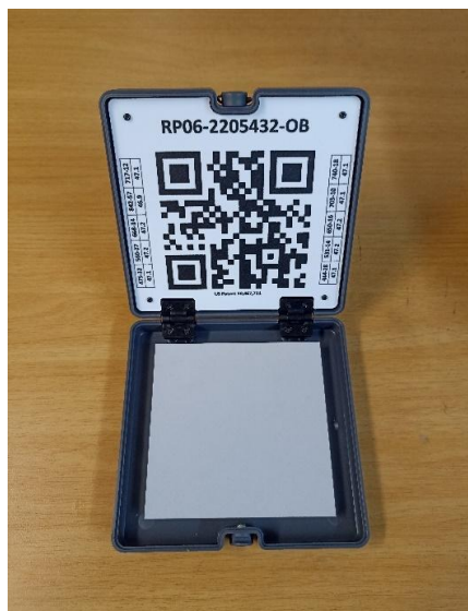
Figura 10 Panel de reflectancia calibrada CRP modelo RP06 de la cámara Micasense RedEdge-Mx Blue. Fuente autor.
