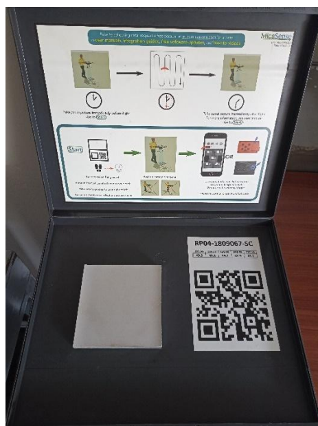
Figura 7 Panel de reflectancia calibrada CRP modelo RP04 de la cámara MicaSense RedEdge-M. Fuente autor.
