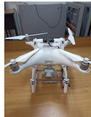
Figura 34 Ensamble completo de la cámara Micasense RedEdge Mx Blue al drone. Fuente autor.
