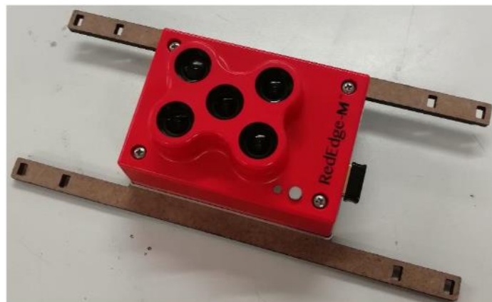
Figura 29 Ensamble cámara Micasense RedEdge M a la base de sujeción. Fuente [88].
