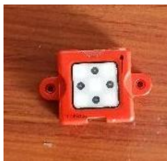
Figura 5 Sensor de luz descendente (DLS) de la cámara Micasense RedEdge-M. Fuente autor.
