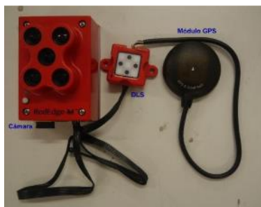
Figura 14 Conexión sistema Micasense RedEdge M. Fuente [81].
