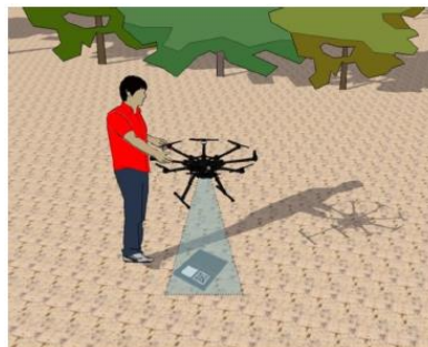
Figura 40 Captura del panel de reflectancia. Fuente [96].
