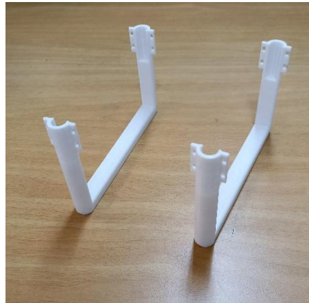
Figura 19 Extensión sistema de aterrizaje para drone Phantom 4. Fuente autor.
