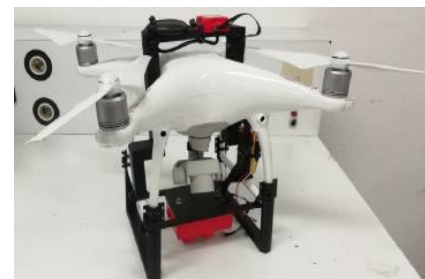
Figura 36 Ensamble completo para la cámara Micasense RedEdge M al drone. Fuente [91].
