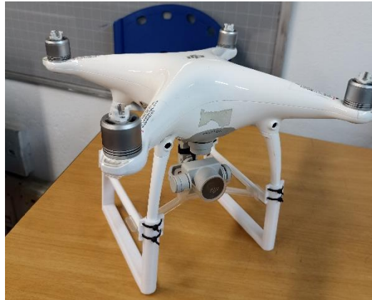
Figura 27 Instalación sistema de aterrizaje. Fuente autor.
