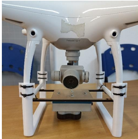
Figura 30 Instalación cámara Micasense Red Edge Mx Blue al dron. Fuente autor.
