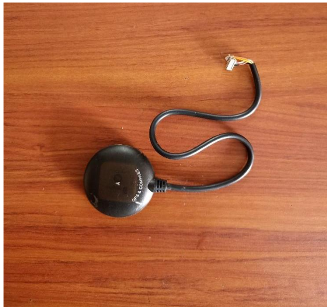
Figura 6 Modulo GPS de la cámara MicaSense RedEdge-M. Fuente autor.
