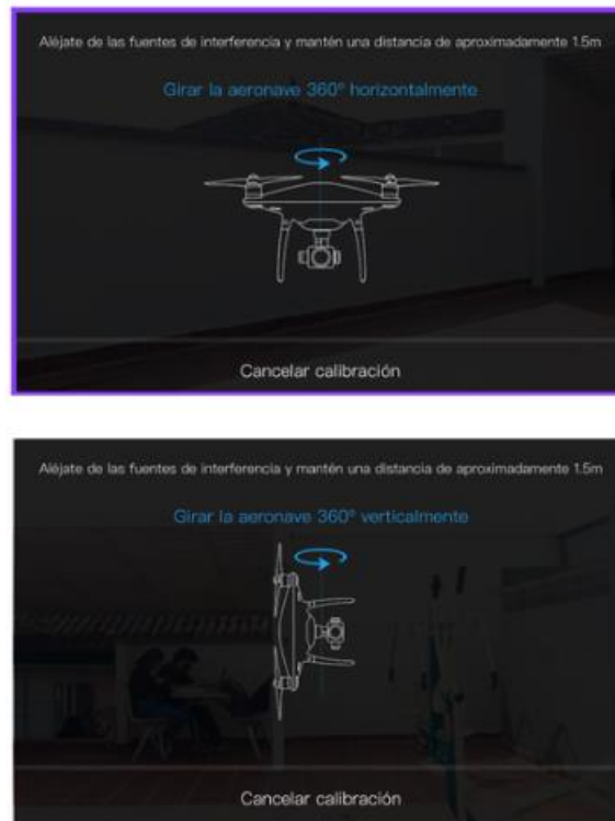
Figura 90 Pasos calibración brújula drone phantom 4. Fuente autor.
