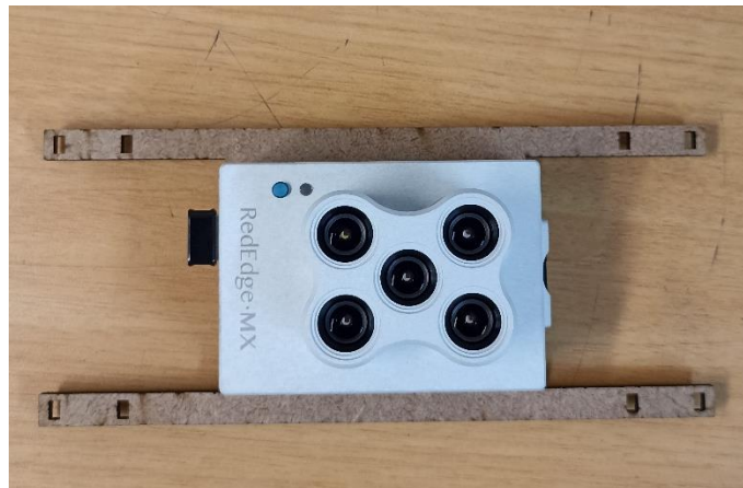
Figura 28 Ensamble cámara Micasense RedEdge Mx Blue a la base de sujeción. Fuente autor.
