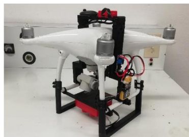
Figura 35 Instalación circuito de alimentación para cámara Micasense RedEdge M al drone. Fuente [90].
