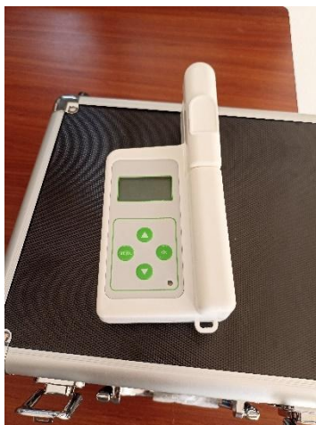
Figura 12 Clorofilometro TYS A. Fuente autor.
