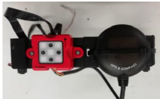
Figura 24 Soporte sensor DLS y módulo GPS. Fuente [87]
