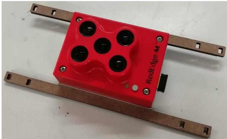
*Figura 29. Ensamble cámara MicaSense Red Edge a la base de sujeción. Fuente autor*
