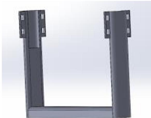
*Figura 21. Diseño extensión tren de aterrizaje para drone DJI Phantom 4. Fuente autor*
