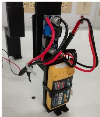
Figura 32. Instalación del circuito de alimentación externa. Fuente autor
