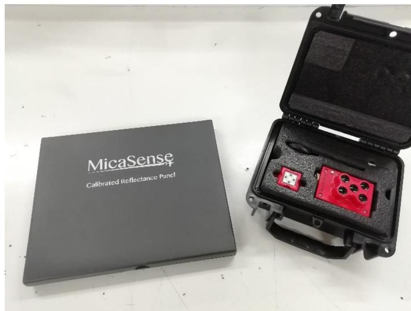
*Figura 13. Kit cámara MicaSense RedEdge-M. Fuente autor*
