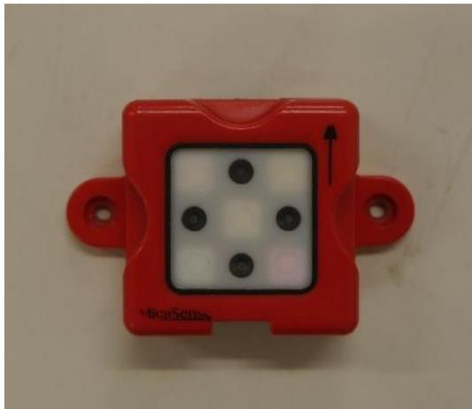
*Figura 14. Sensor de luz descendente (DLS) de la cámara MicaSense RedEdge-M. Fuente autor*
