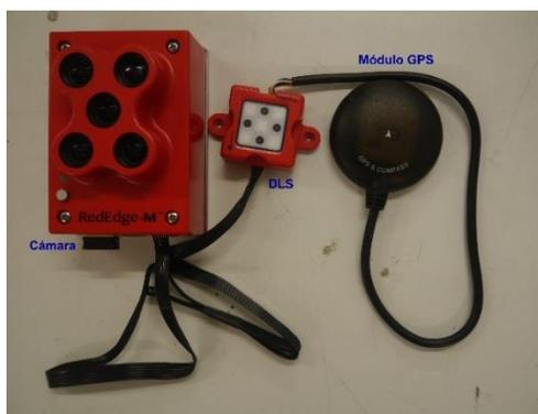
Figura 18. Conexión sistema MicaSense Red Edge M. Fuente autor
