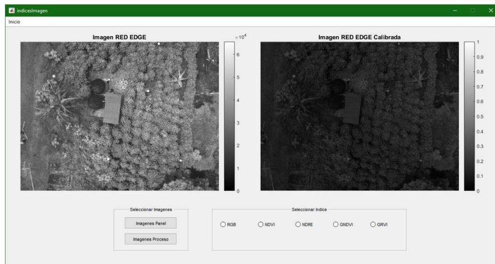
Figura 129. Visualización de calibración imagen RedEdge. Fuente autor
