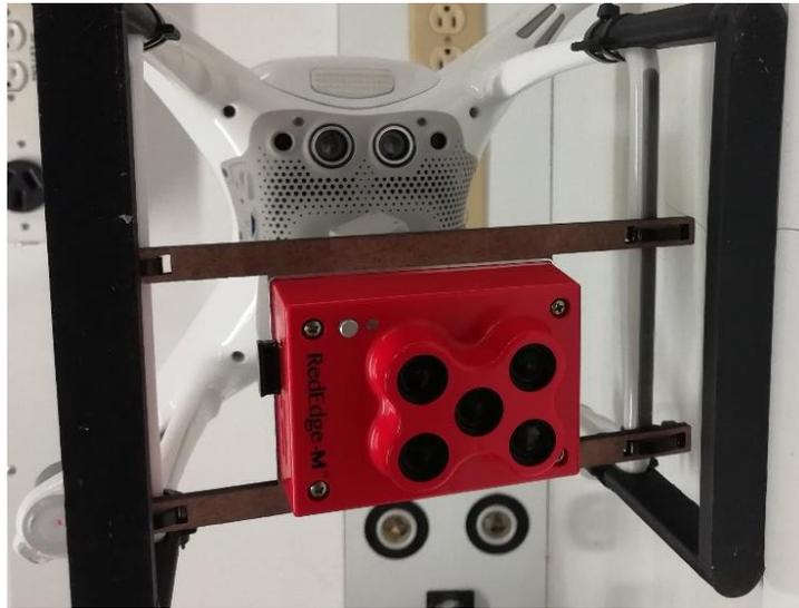
Figura 31. Vista inferior del ensamblaje entre la cámara MicaSense Red Edge M y dron DJI Phantom 4. Fuente autor
