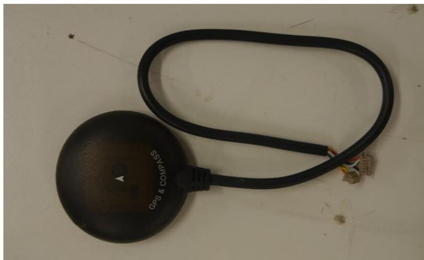
Figura 15. Modulo GPS de la cámara MicaSense RedEdge-M. Fuente autor
