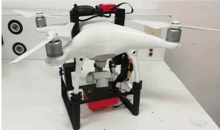
*Figura 38. Ensamble completo de la cámara MicaSense Red Edge M y drone DJI Phantom 4. Fuente autor*
