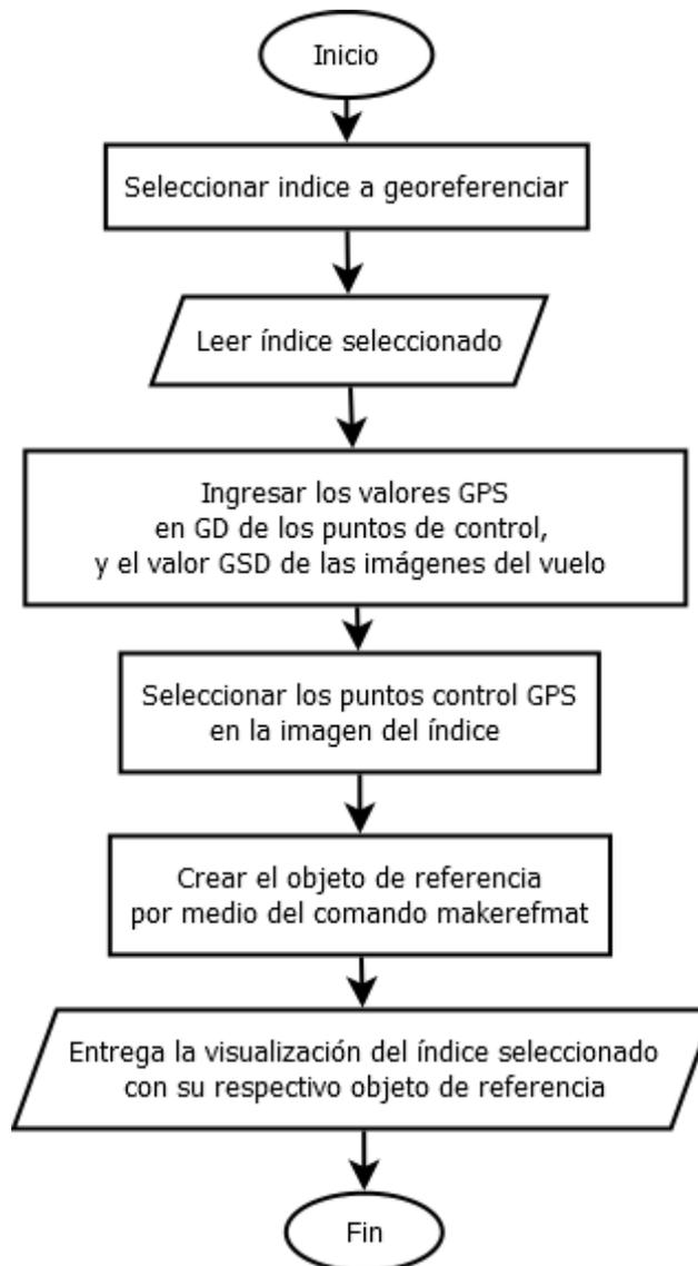
Figura 77. Diagrama de flujo georeferenciación. Fuente autor.
