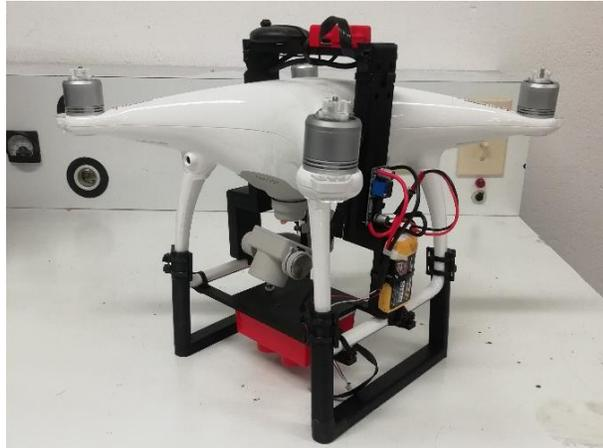
Figura 35. Instalación circuito de alimentación al drone DJI Phantom 4. Fuente Autor
