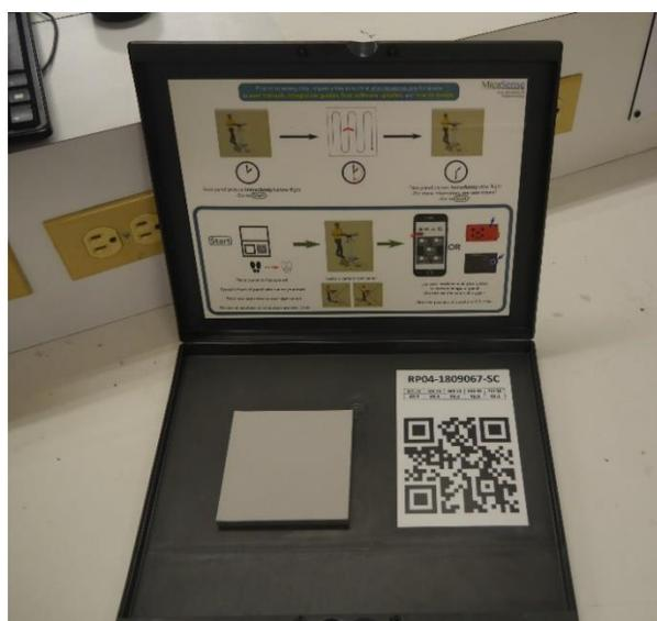
Figura 16. Panel de reflectancia calibrada CRP de la cámara MicaSense RedEdge-M. Fuente autor
