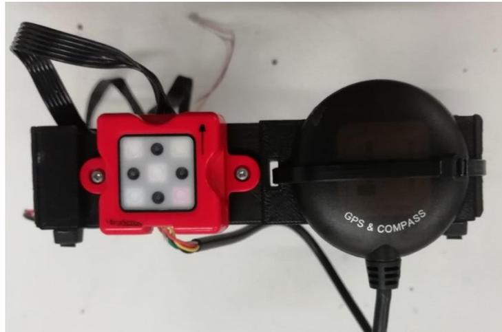
*Figura 33. Instalación sensor DLS y modulo GPS. Fuente autor*
