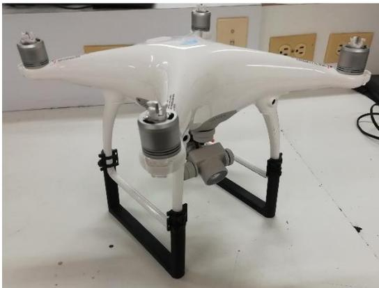
*Figura 28. Instalación extensión de tren de aterrizaje. Fuente autor*
