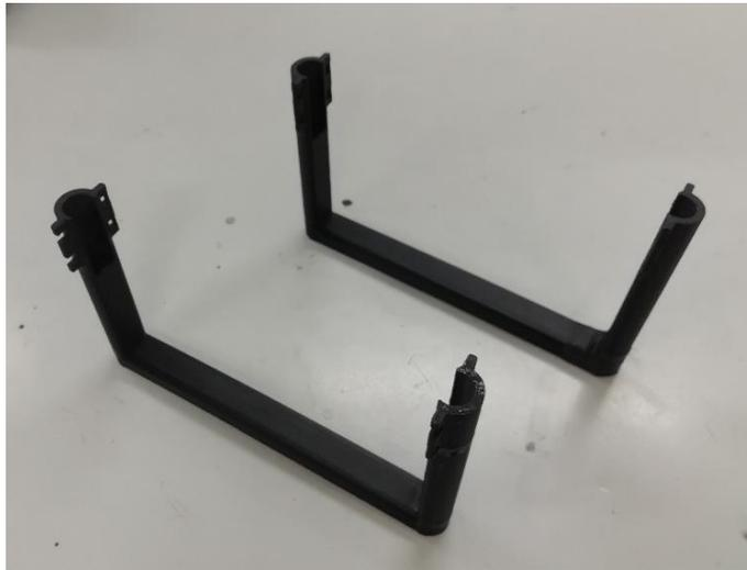
*Figura 22. Extensión tren de aterrizaje de drone Phantom 4. Fuente autor*
