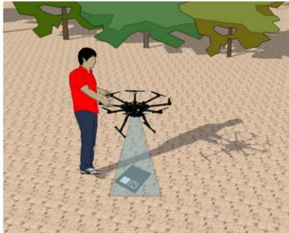
Figura 55. Captura del panel de reflectancia calibrada. Fuente [39]
