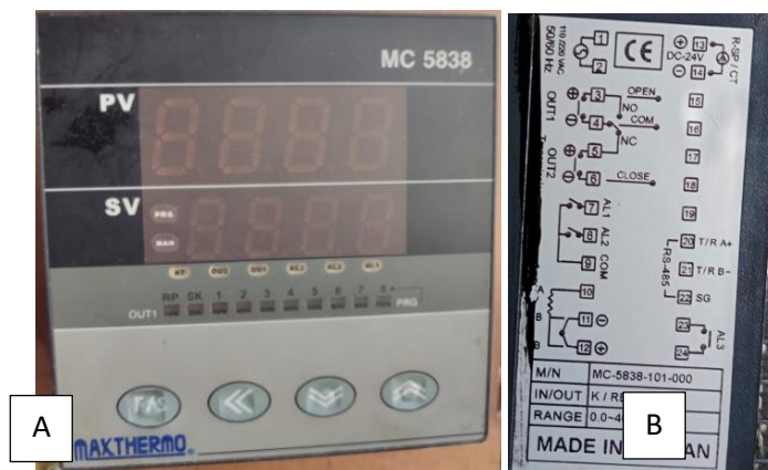
FIGURA 31: A Driver controlador de temperatura: (maxthermo ® MC5853) – B Diagrama de conexiones Driver de controlador de temperatura (maxthermo ® MC5853). Fuente MAXTHERMO ®
