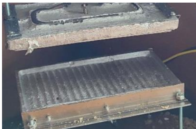
FIGURA 36:Implementación de placas a máquina de termoformado
