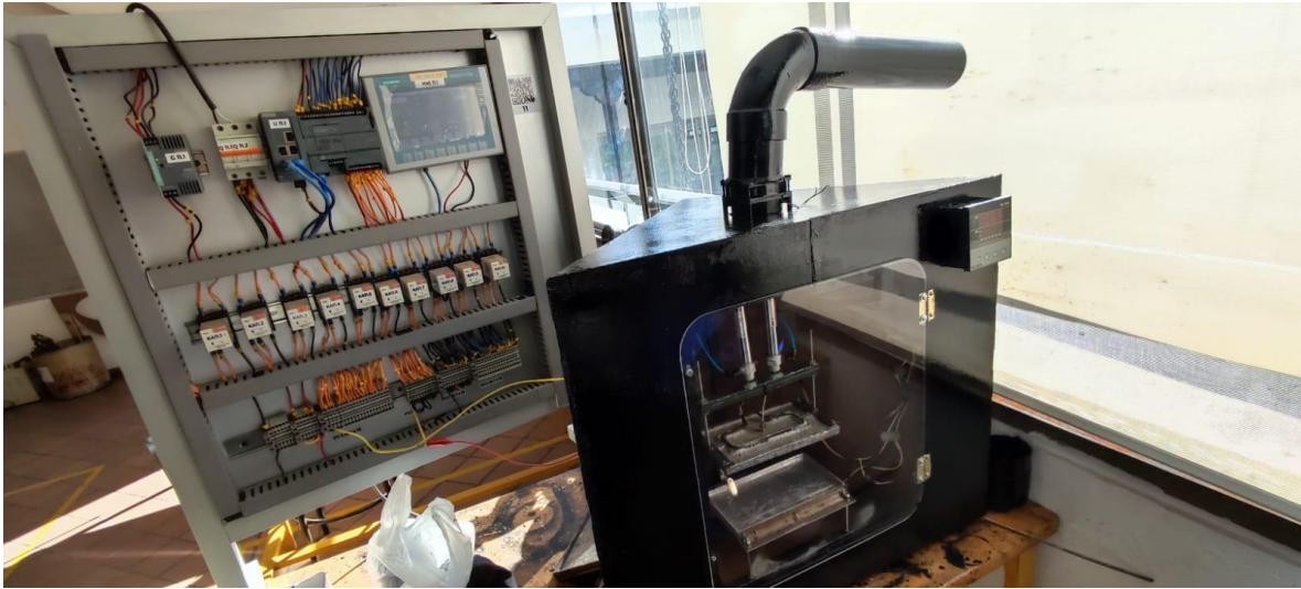
FIGURA 38: Prototipo de termo formadora por compresión. Fuente: propia.
