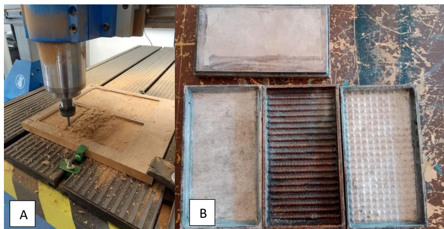
FIGURA 33: A Fabricación CAM (fresa CNC) - B Moldes de termoformado fabricadas en MDF: Fuente Propia.
