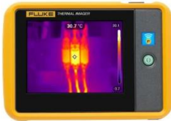
FIGURA 5: Cámara termográfica flukePTi20. FUENTE de: [20]
