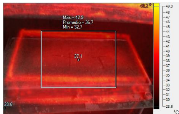
FIGURA 71: Temperatura placa triangular a los 5 minutos
