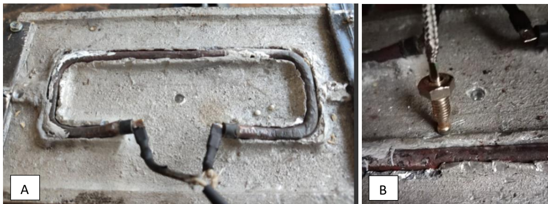
FIGURA 35 :A Implementación de resistencia a placa de termoformado – B Implementación de termocupla
