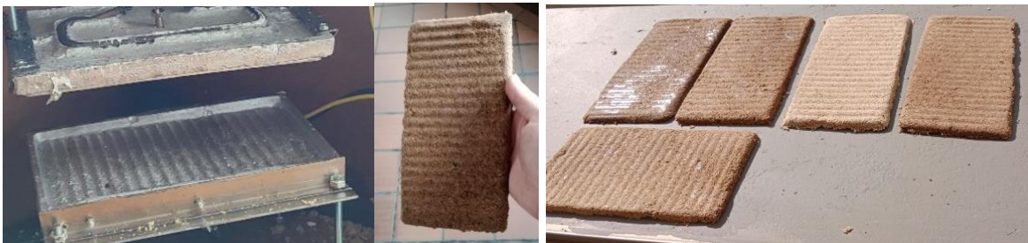
FIGURA 62: Placas de conglomerado y polvillo de fique con geometría(piramidal)
