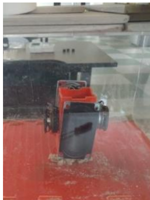
FIGURA 48: Caja con parlantes posicionados y amplificadores PAM 8403
