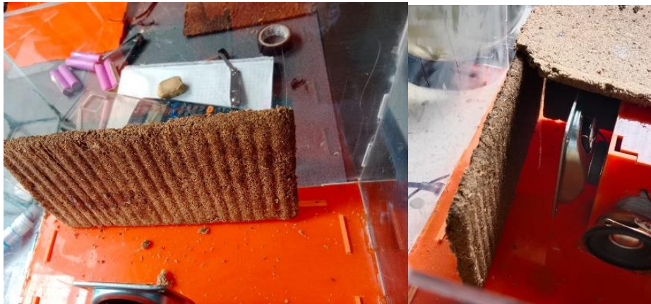
FIGURA 66 : Pruebas acústicas en acámara anecoica (placas piramidales)
