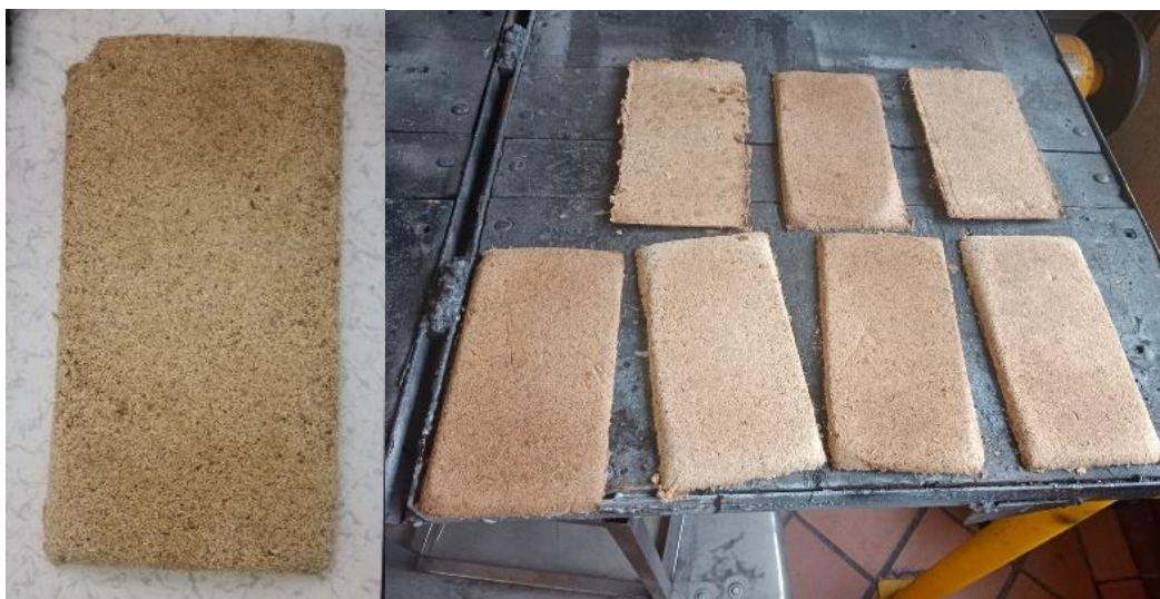
FIGURA 63: Placas de conglomerado y polvillo de fique sin geometría(planas)
