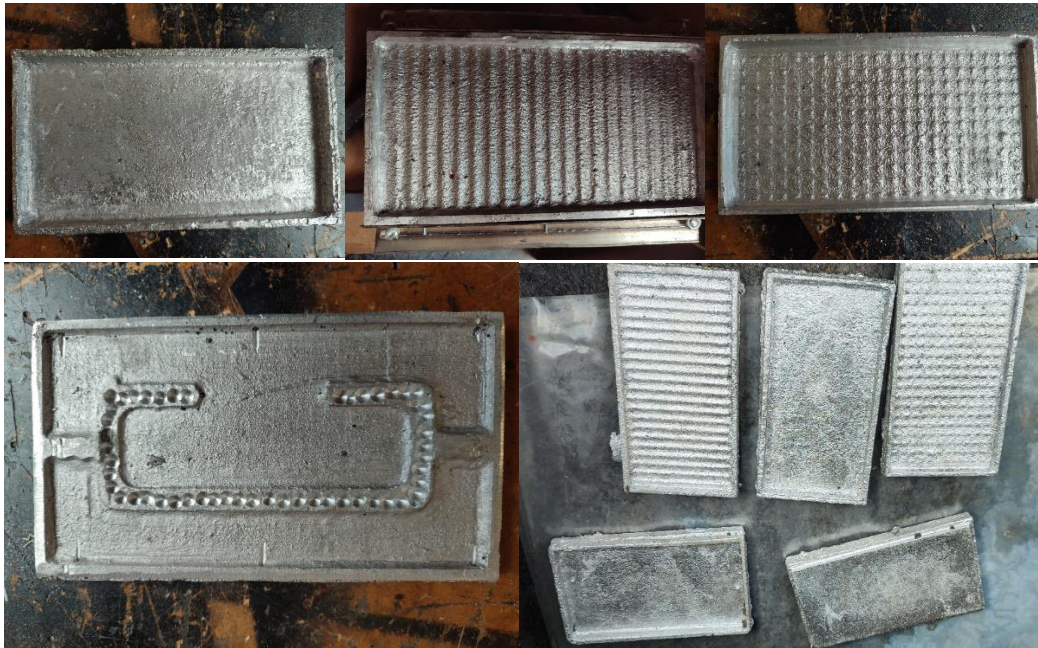
FIGURA 34: Placas de termoformado fabricadas en aluminio.
