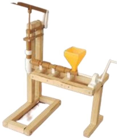
*Figura 33 Prototipo de inyección de dos etapas impresos en 3d, escalados en  $\frac{1}{2}$  del tamaño real. Fuente: propia.*
