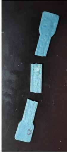
*Figura 66 Resultado fallido de inyección de material para probeta azul al someterse a altas temperaturas.
