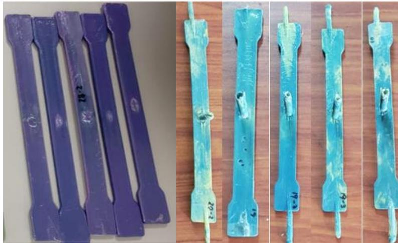
Figura 67 Probetas de pruebas resultantes de la mezcla de material amarillo con azul (AA) y morado con azul (MA). Fuente: propia.
