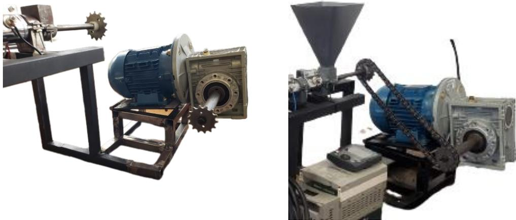
*Figura 48 Posición del motor y conexión hacia el husillo. Fuente: Propia.*
