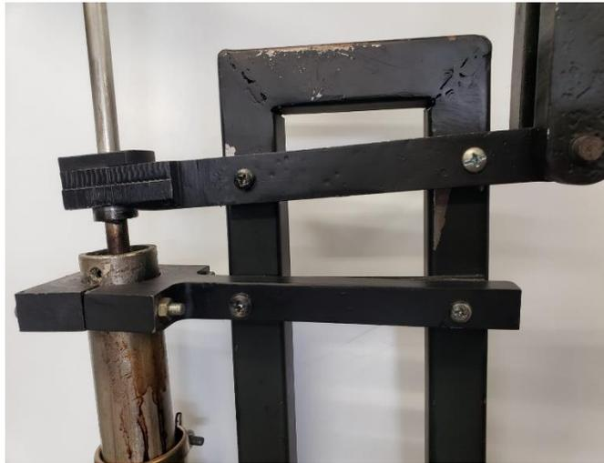
*Figura 44 Soportes del cilindro de inyección. Fuente: propia.*
