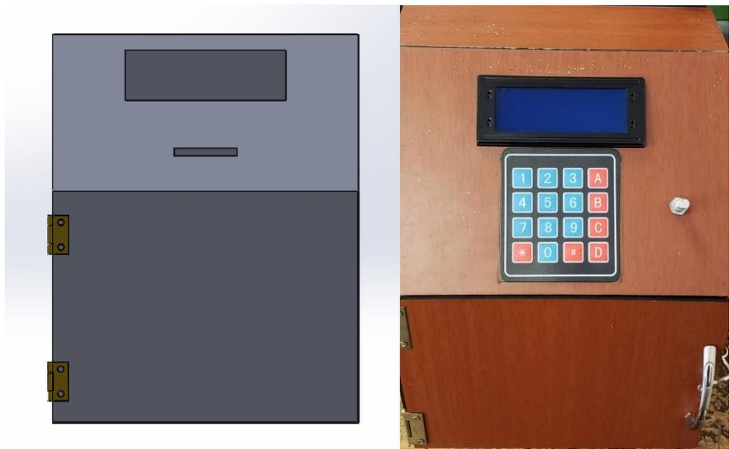
*Figura 57 Panel del control del prototipo. Fuente: propia.*
