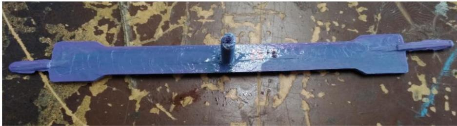
*Figura 65 Primer resultado de inyección para la mezcla azul-morado (AM). Fuente: propia.*
