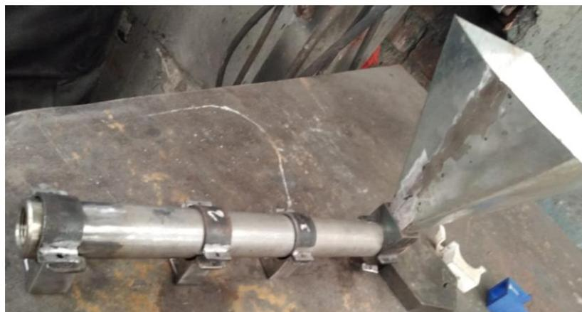
*Figura 41 Montaje de los soportes y la tolva al cilindro extrusor. Fuente: propia.*
