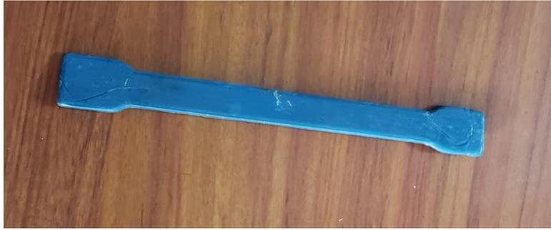
*Figura 64 Resultado de inyección de material azul para fabricación de probeta. Fuente: propia.*
