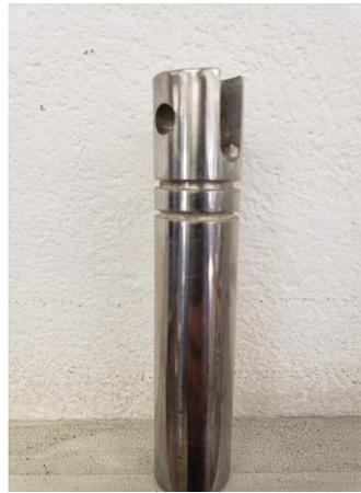
*Figura 42 Pistón del sistema de inyección. Fuente: propia.*
