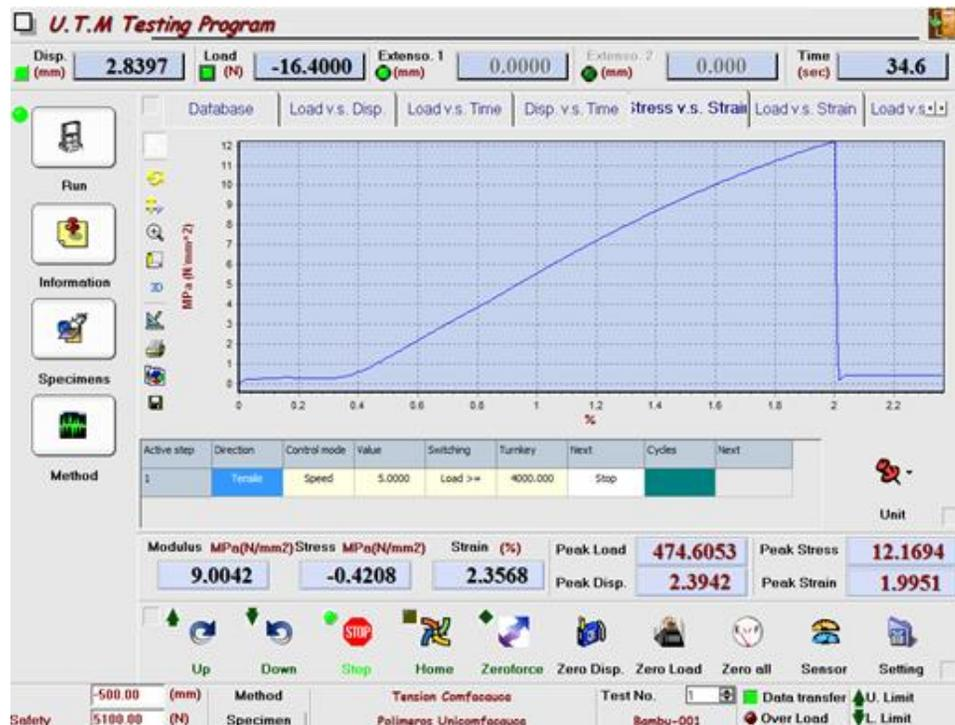
Figura 76 Representación visual de la ejecución del software para ensayos de tracción. Fuente: propia.
