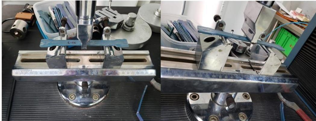
*Figura 83 Ensayo de flexión en probetas con la Máquina Universal de Ensayos. Fuente: propia.*
