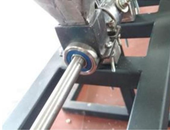
*Figura 38 Encaje simétrico de la balinera con el cilindro de extrusión y el barreno. Fuente: propia.*
