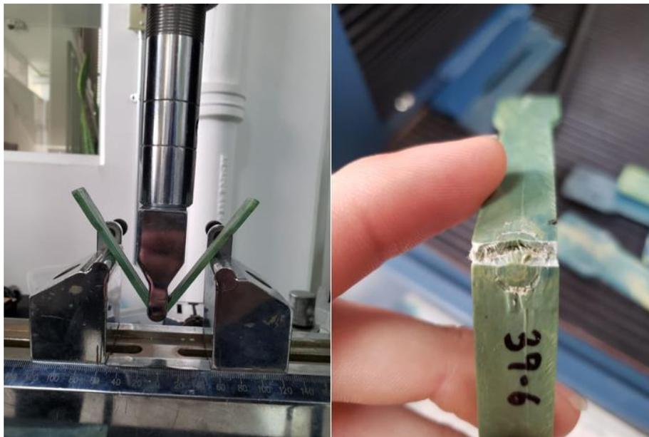
*Figura 86 Fractura de probeta y visualización de fibras que la mantienen unida después de fracturación.
