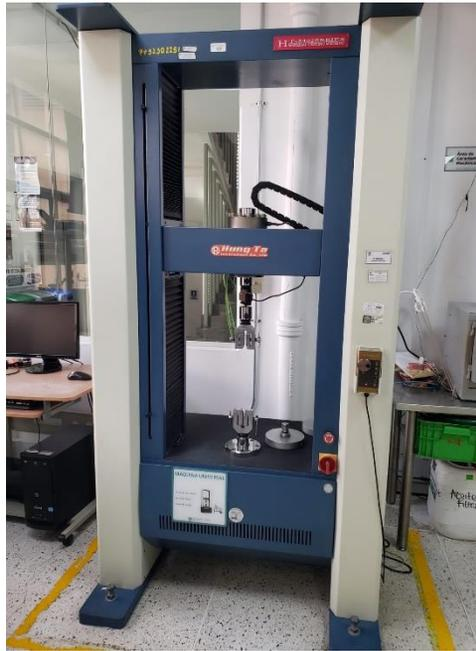
Figura 74 Máquina Universal de Ensayos. Fuente: propia.
