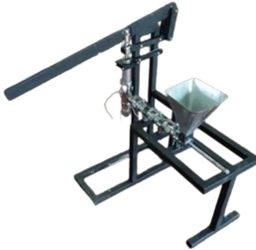
*Figura 46 Maquina prototipo con los sistemas de extrusión e inyección establecidos. Fuente: propia.*
