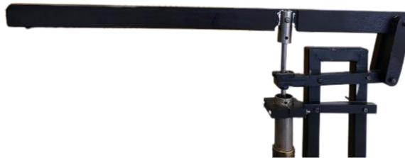
*Figura 43 Palanca del sistema de inyección. Fuente: propia.*
