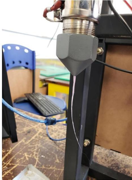
*Figura 45 Boquilla de 5 milímetros del sistema de inyección. Fuente: propia.*
