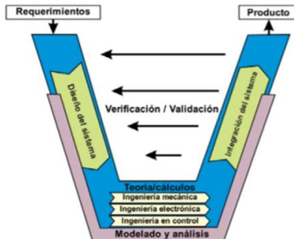
Figura 11 Metodología de Diseño Mecatrónico modelo en V.
