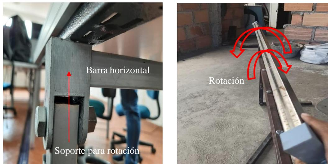
*Imagen 2 Barra de Base Móvil para control manual fuente: propia*
