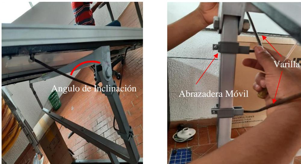
Imagen 6. Abrazadera Móvil con varillas fuente: propia
