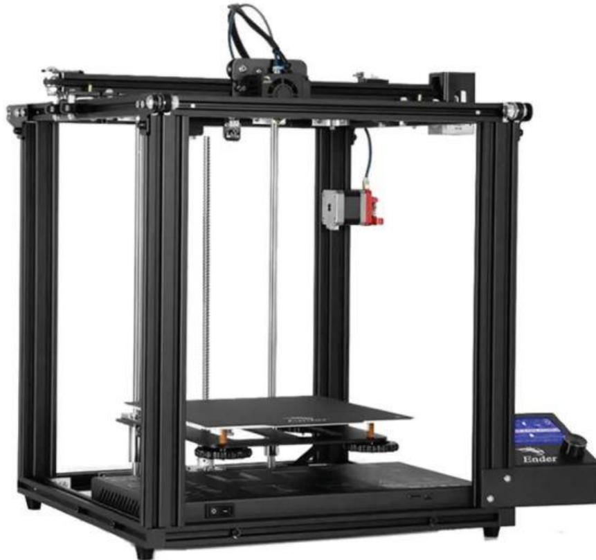
*Fig.54 Impresora Creality Ender 5 utilizada para la impresión de la órtesis y férula desarrollada en el proyecto. [26]*
