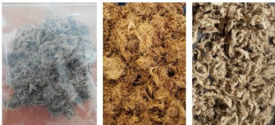
Figura 47. Fibra de pseudotallo, lavada en agua destilada y tratamiento alcalino con pH neutro y secado en horno tipo mufla.
