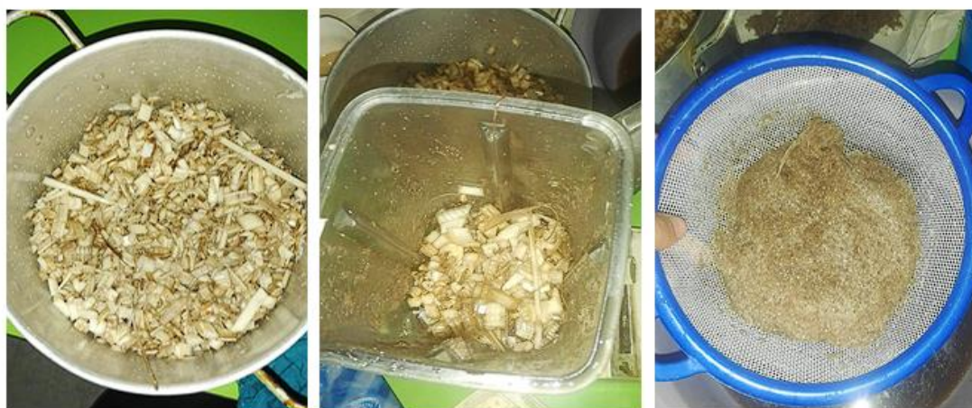
Figura 22. Adecuación de la materia prima mostrando el pseudotallo del plátano obtenido.
