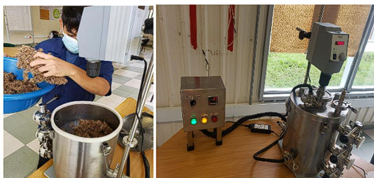
Figura 31. Tratamiento de las fibras de pseudotallo en el biorreactor.
