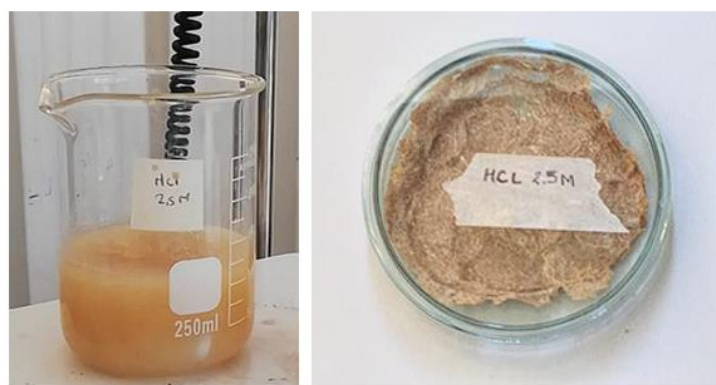
Figura 48. Hidrólisis Ácida con ácido clorhídrico (2.5 M).
