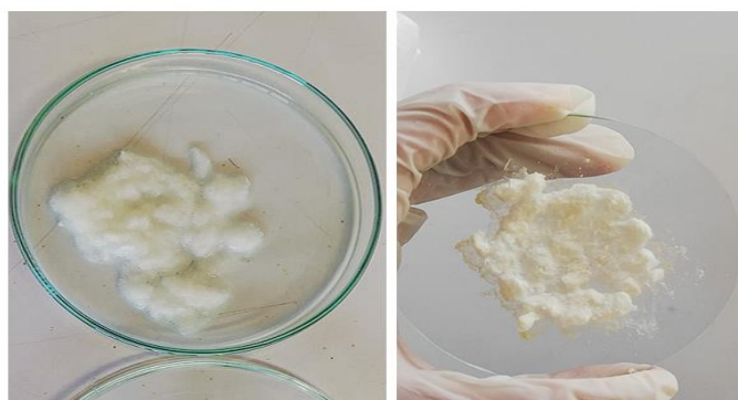
Figura 37. Hidrólisis alcalina en NaOH al 5% + H_2O_2 al 10%.
