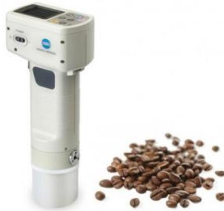
Figura 4. Colorímetro CR-410HS-C. Fuente (aquateknica, 2020)
