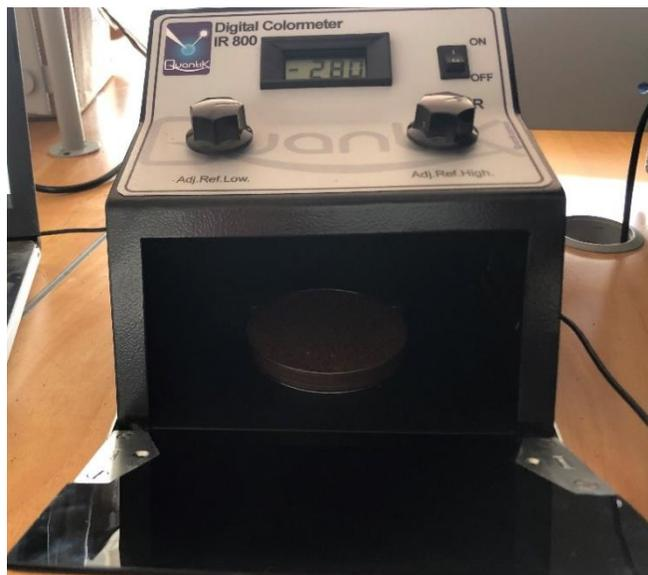
*Figura 9. colorímetro digital QUANTIK IR-800. Fuente autor.*
