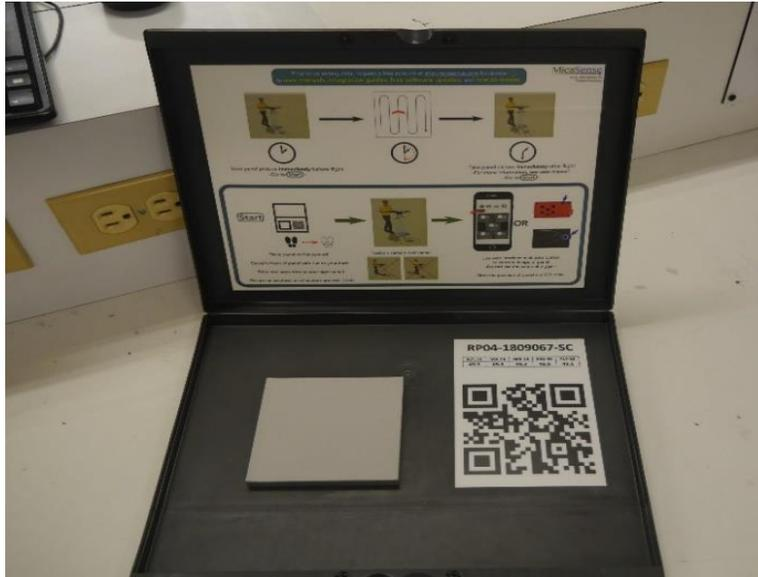
Figura 12. Panel de reflectancia calibrado (CRP). Fuente autor.
