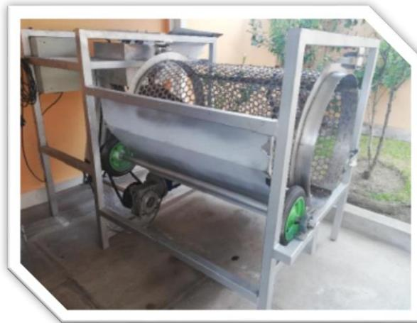
Figura 4. Máquina cortadora y despulpadora de Cacao [15]
