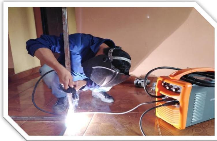
Figura 52. Unión de la estructura [Elaboración propia].
