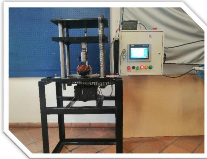
Figura 31. Máquina universal de ensayos [Elaboración propia].
