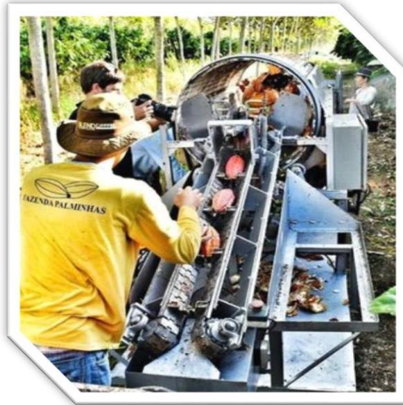
Figura 5. Cortadora y separadora máquina de Cacao [14].
