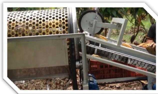
Figura 6. Sistema de corte por discos [18].
