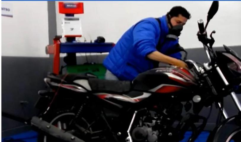
Fig. 19. Operario realizando la prueba de gases. [52].
