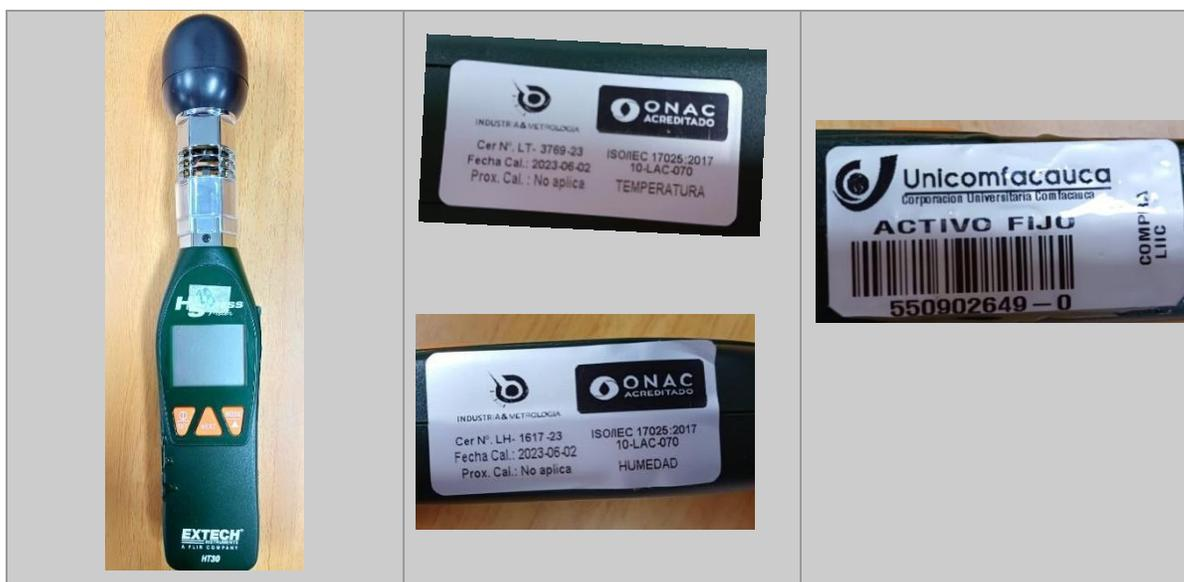
Fig. 30. Sensor de estrés térmico Extech HT30 y certificado de calibración. [63]
