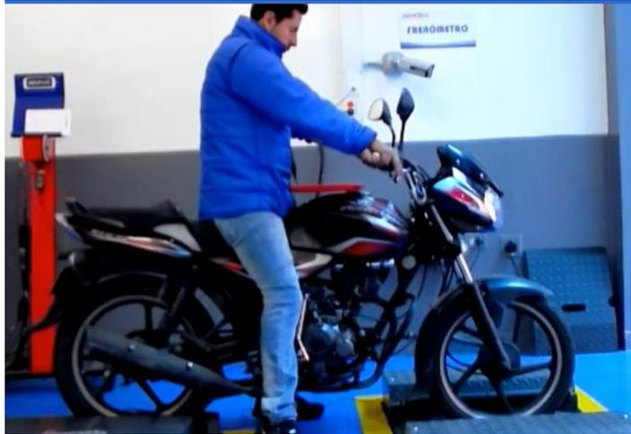
Fig. 18. Operario realizando la prueba de frenos. [52].
