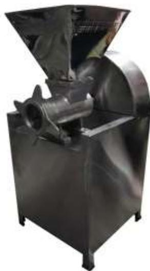
**Fig. 56. Molino eléctrico.**
