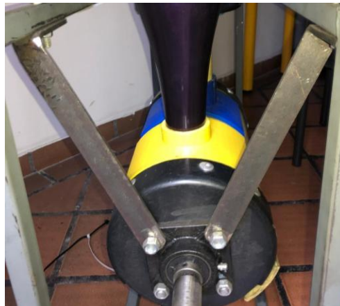
Figura 58. Soportes para la sujeción de la sección de mezclado a la estructura principal
