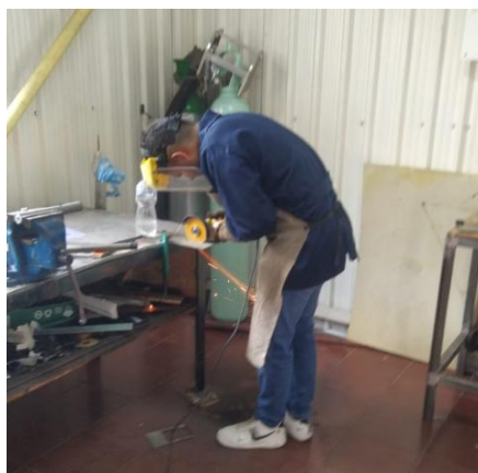
Figura 47. Corte de aspas de lámina de acero inoxidable
