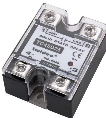
Figura 27. Modulo relé estado sólido de 25A. [51]
