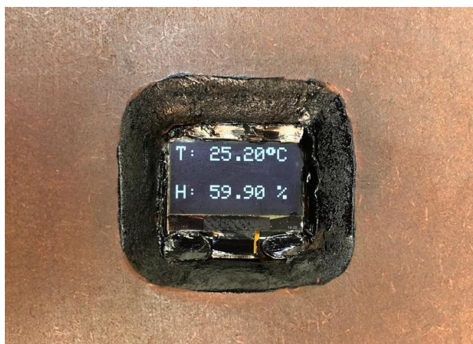
Figura 61. Pantalla OLED para monitoreo de temperatura y humedad del compost
