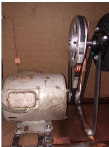
Figura 60. Montaje de motor encargado de la rotación de la sección de rotación
