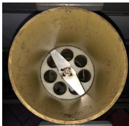
Figura 46. Trituración sin falencia por el sistema de cuchillas y sin falencias de depósito en las mallas
