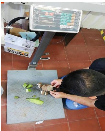
Figura 17. Deducción de fuerza necesaria para corte de materia orgánica
