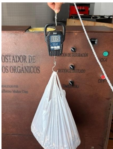
Figura 74. Reducción de peso equivalente al 67,7 de su peso inicial Fuente propia
