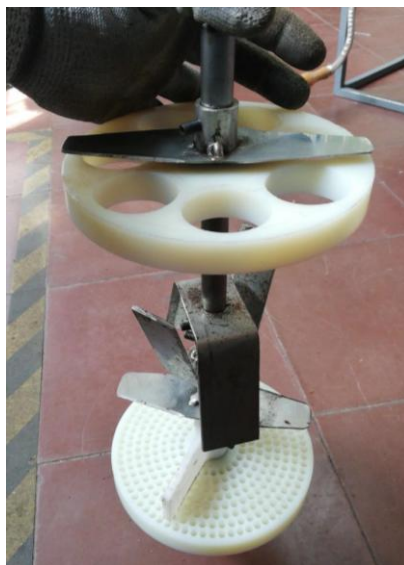
Figura 45. Mecanismo interno de la sección de trituración con su diseño final
