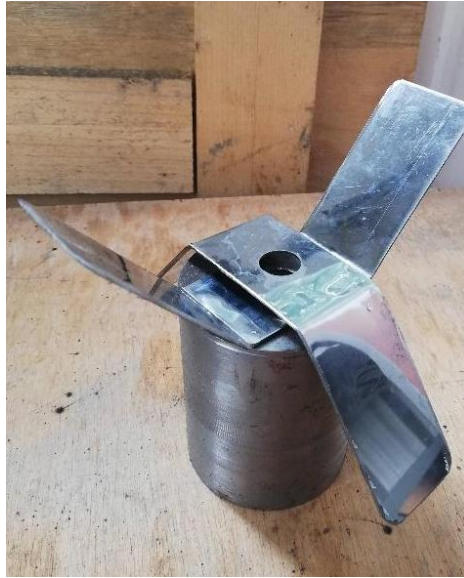
Figura 39. Diseño final de las cuchillas encargadas de la segunda fase en la sección de trituración
