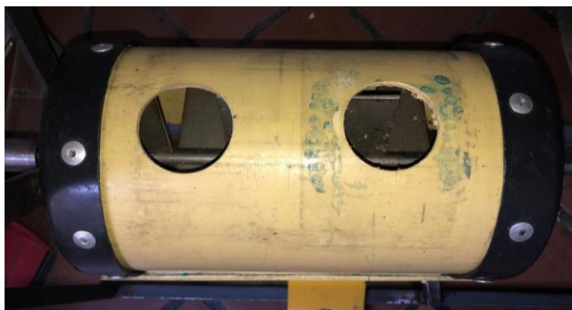
Figura 53. Perforaciones circulares en la sección de mezclado
