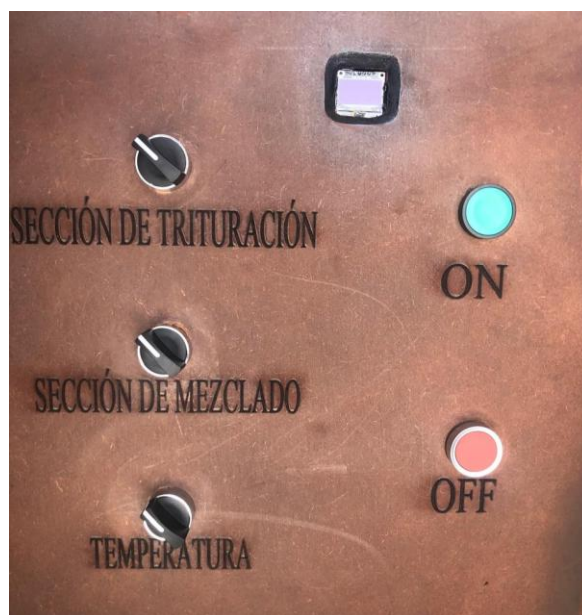
Figura 62. Interruptores para el accionamiento manual de las diferentes secciones del compostador
