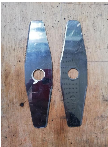
Figura 38. Diseño final de las cuchillas encargadas de la primera sección en la fase de trituración
