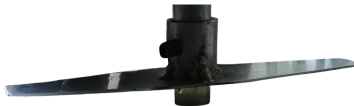
Figura 43. Bujes soldados sobre las cuchillas y sujetos sobre el eje de rotación
