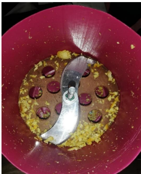
Figura 37. Cáscara de naranja triturada por las cuchillas, pero con dificultad de corte por el diseño elaborado y diámetro de material
