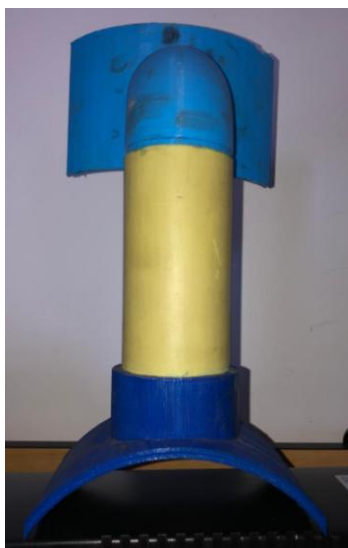
Figura 54. Ducto conductor de la materia orgánica triturada
