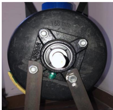
Figura 50. Sujeción de eje de rotación y rodamientos de base cuadrado a tapa de PVC
