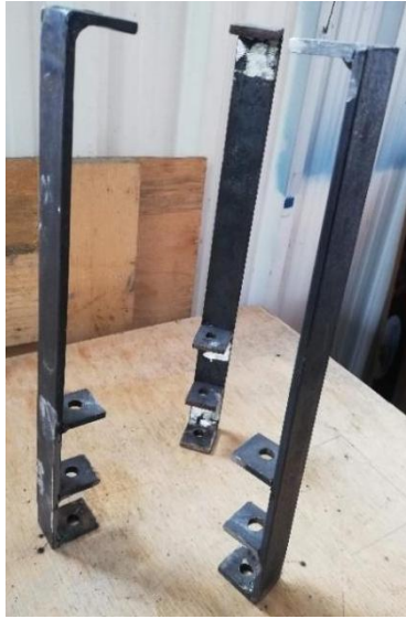
Figura 41. Diseño final de los soportes encargados la distribución y sujeción de los mecanismos que conforman la sección de trituración
