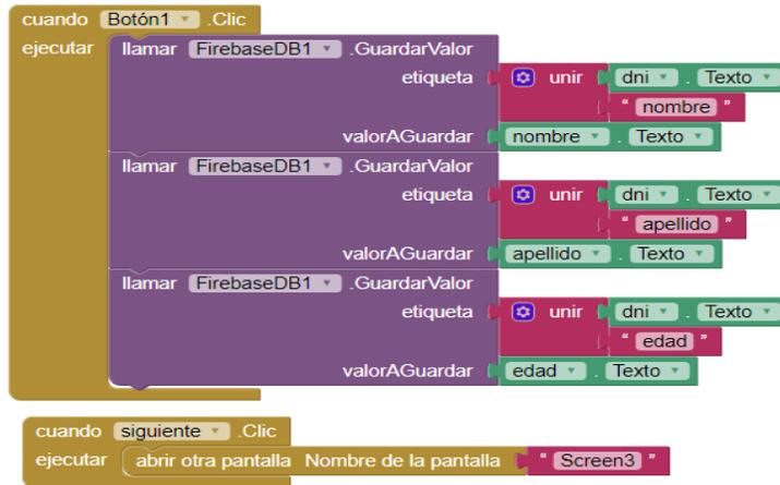
Figura 46 Diagrama de bloques para funcionamiento de la segunda pantalla
