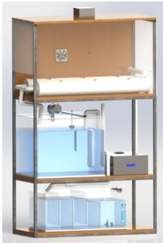
*Ilustración 7. Diseño del sistema acuapónico. (autor).*
