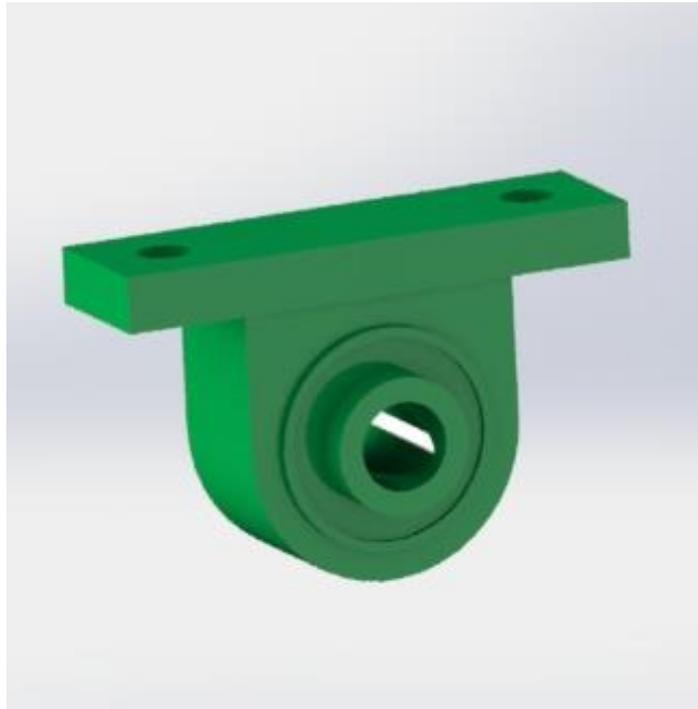
**Figura 21. Diseño CAD chumacera soporte de elevación de camilla**
