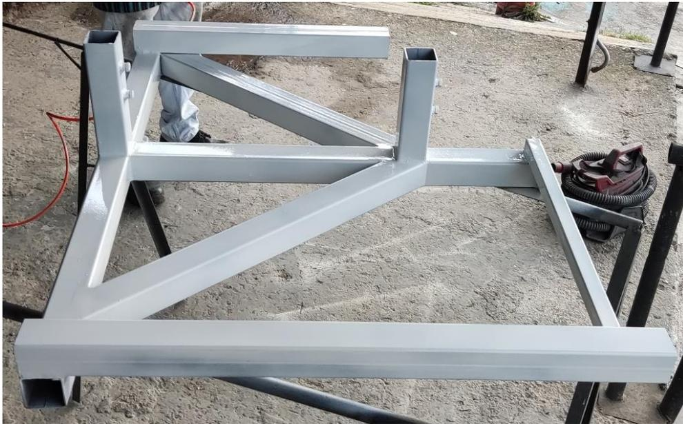
**Figura 42. Aplicación de varias capas de anticorrosivo**
