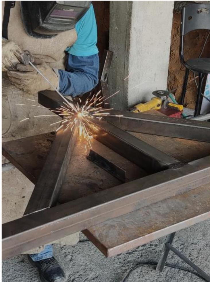
**Figura 41. Utilización de soldadura de arco eléctrico**
