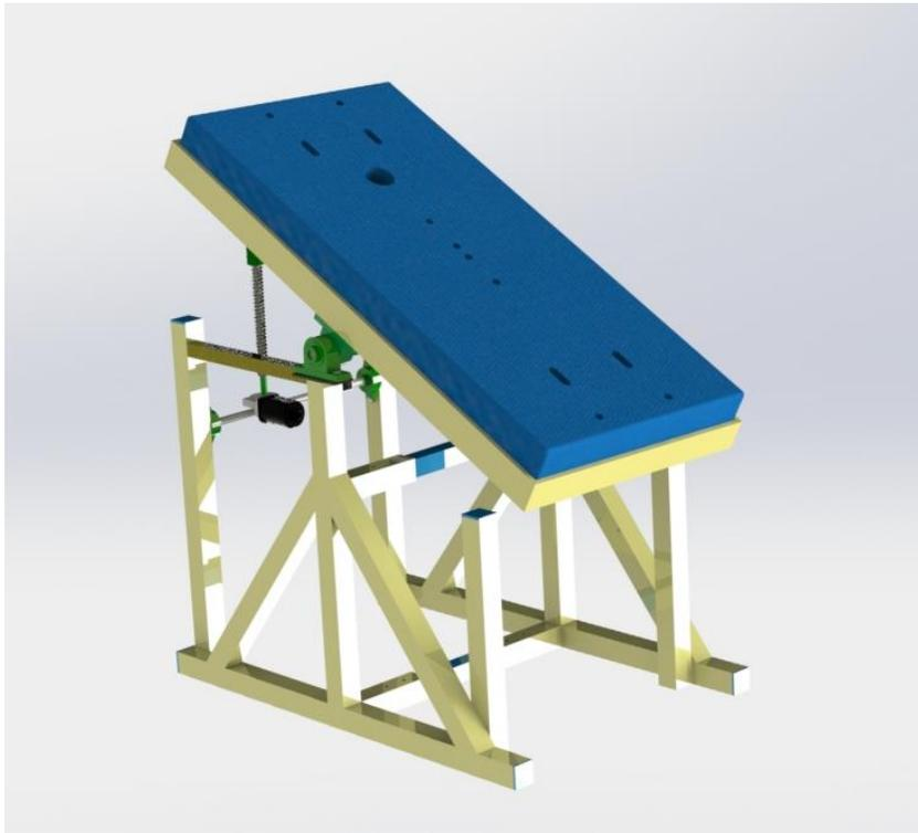
**Figura 30. Diseño CAD sin sistema vibratorio**
