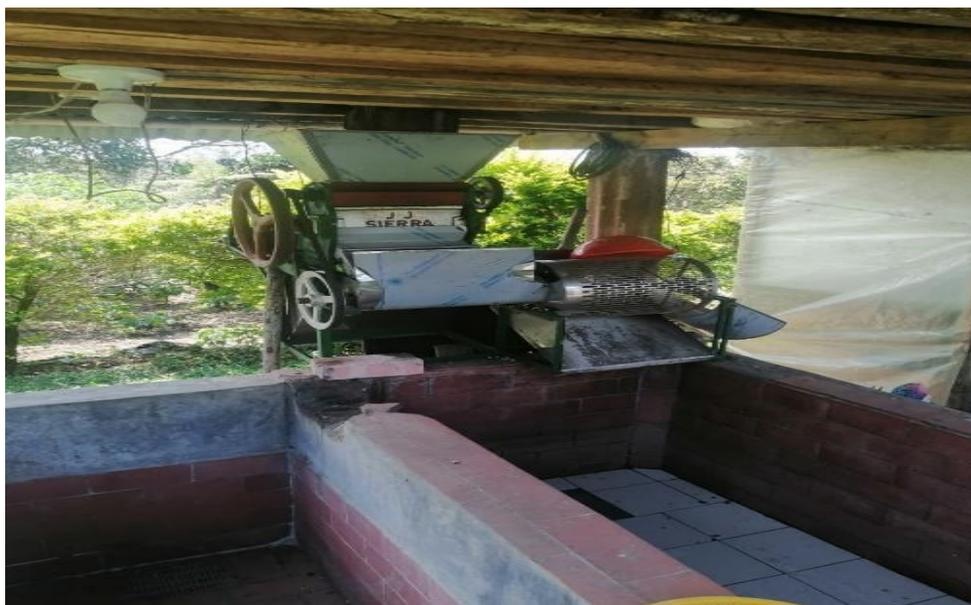
*Fuente: maquinaria de despulpado, separación de cereza y cascara, para su posterior fermentación, lavado y secado, fotografía propia*
