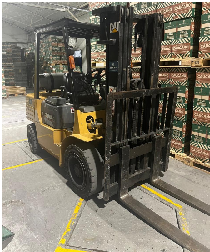
Imagen 67 Montacargas a gasolina GP30. Fuente: Autor.
