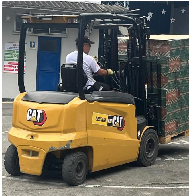
Imagen 66 Montacargas eléctrico EC20LN2-2. Fuente: Autor.
