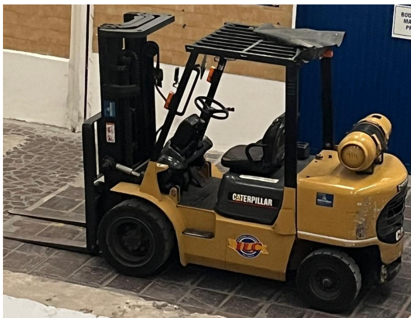
Imagen 68 Montacargas a gasolina GP30K. Fuente: Autor.
