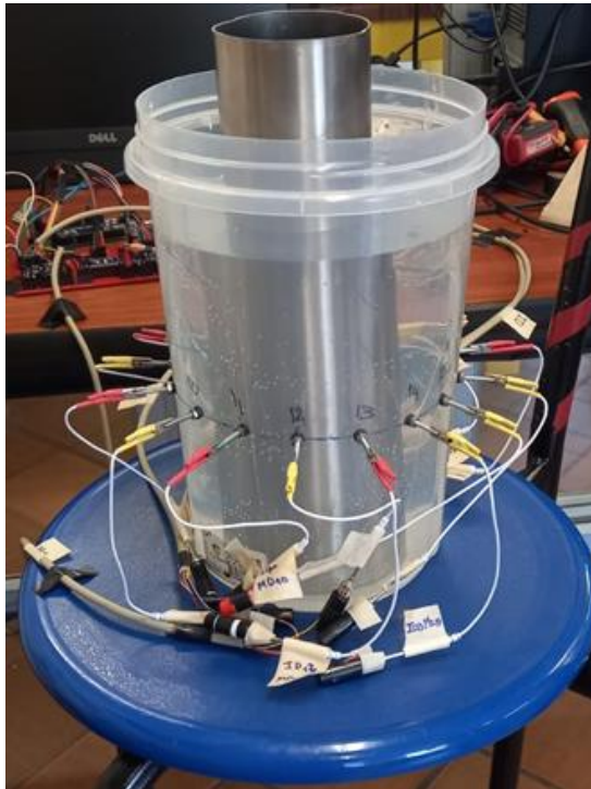
Figura 31. Tanque de solución salina con tubo de acero.
