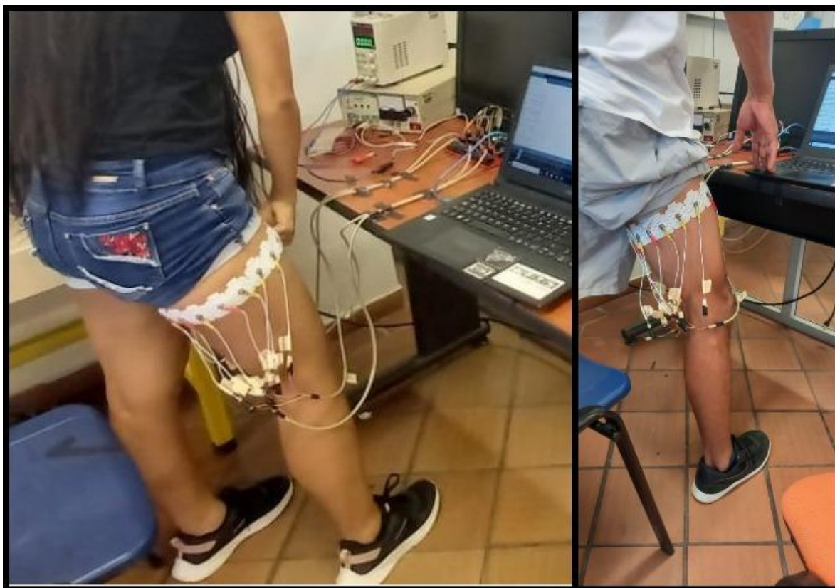
Figura 36. Medición de impedancia alrededor de la pierna en voluntario de contextura gruesa y delgada.
