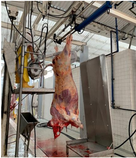
Figura 12. Corte de canal con sierra eléctrica (Fuente el autor)
