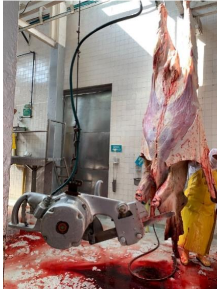
Figura 9. Estación de corte de esternón con sierra eléctrica (Fuente El autor)
