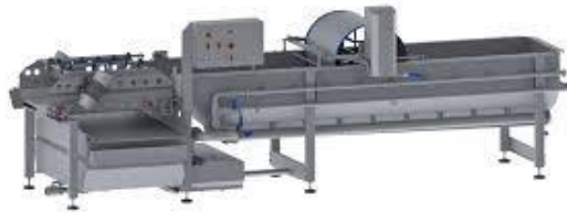
Figura 39. Lavadora y desinfectadora de frutas.
