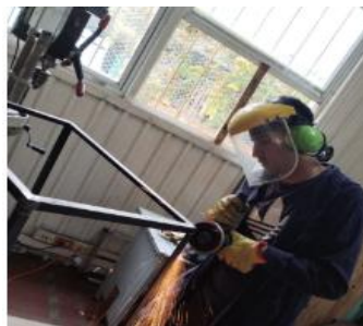
Figura 58. Pulido de la estructura metálica del sistema de incubación. Fuente: Elaboración propia
