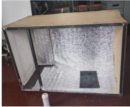
Figura 61. Ensamble de la estructura con el cajón de MDF unido con tornillos.
