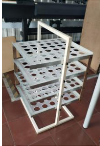
Figura 71. Sistema de volteo de huevos acoplado con las bandejas hechas en acrílico. Fuente: Elaboración propia
