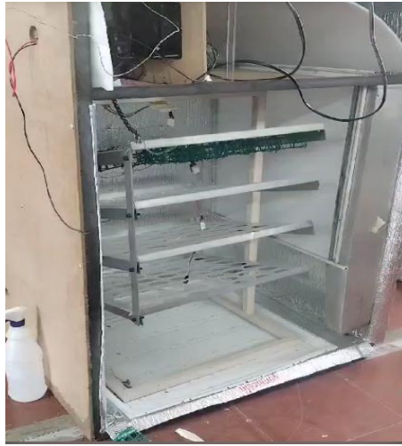
Figura 80. Ubicación de los sensores en cada bandeja
