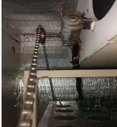
Figura 74. Sistema piñón cadena utilizado para el volteo de los huevos a 45°.
