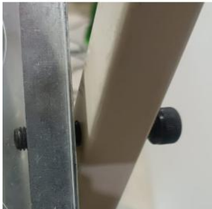
Figura 73. Tornillos pasantes empleados para asegurar las bandejas al soporte.
