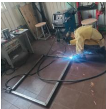
Figura 66. Soldando la estructura metálica de la puerta para el sistema de incubación.
