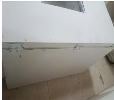
Figura 69. Bisagras ubicadas estratégicamente entre la puerta y la incubadora. Fuente: Elaboración propia
