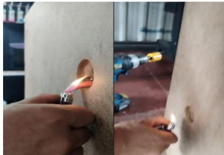
Figura 82. Verificación de renovación de aire dentro de la incubadora Fuente: Elaboración propia
