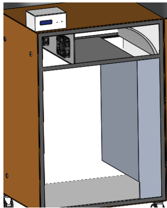
Figura 22. Sistema para el flujo del aire dentro de la incubadora Fuente: Elaboración propia.
