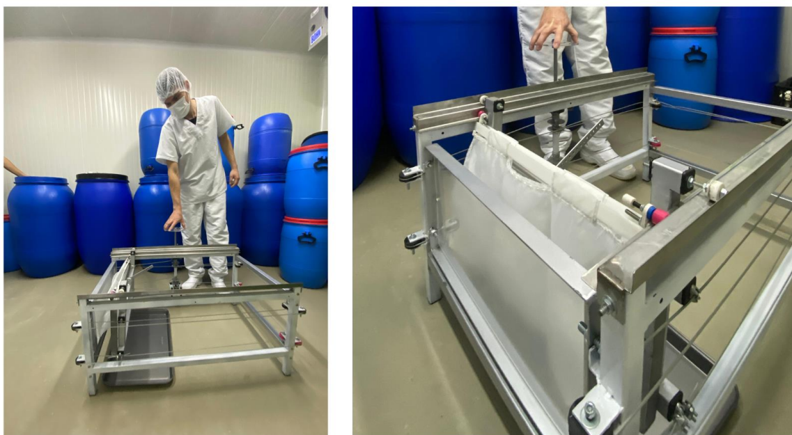
Figura 47 Prueba de funcionamiento de manivela, guayas y rodamientos en el cuarto frío, elaboración propia
