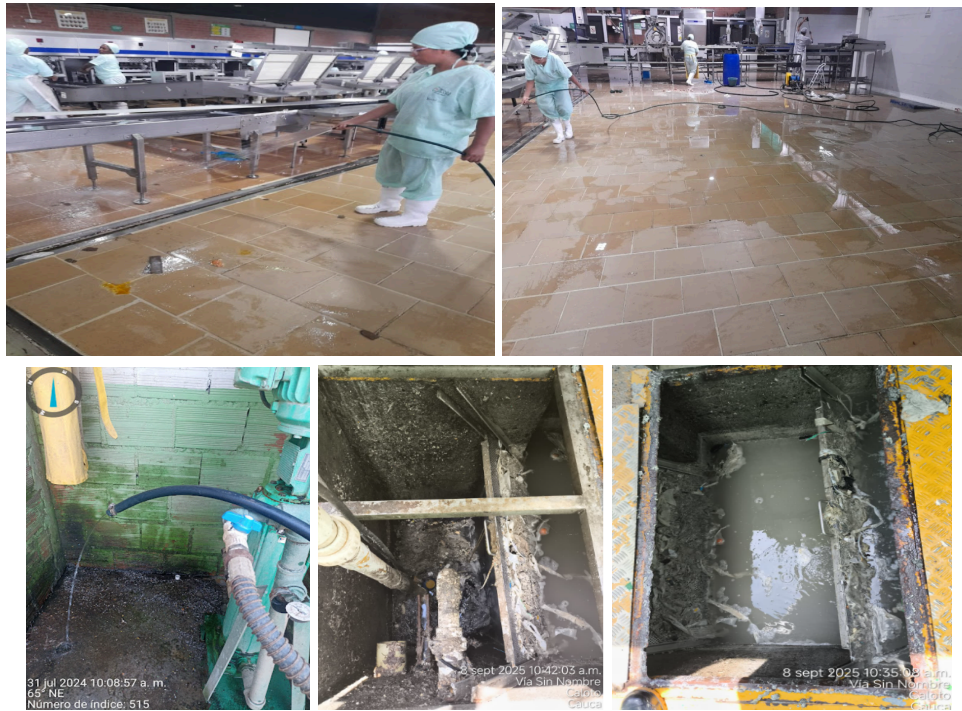
Figura 9: Imagen del uso ineficiente de mangueras en puntos alejados.
