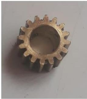
Figura 61. Engrane latón (Propio)
