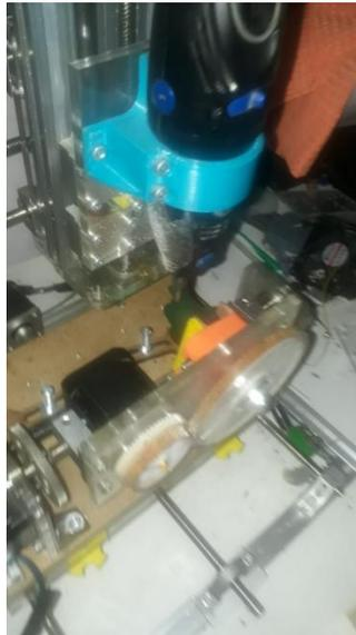
Figura 135.pieza siendo mecanizada por Máquina cnc de 5 ejes (Propia)
