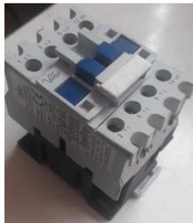
Figura 67.Contactor eléctrico (Propia)
