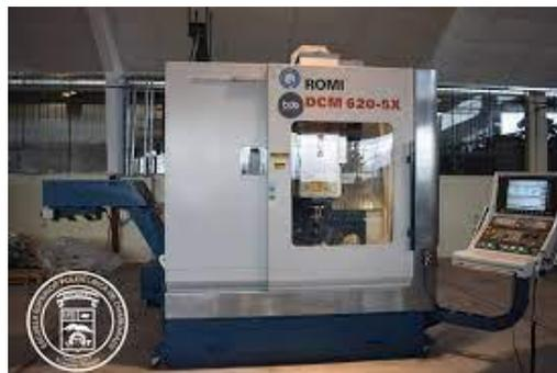
Figura 47.fresa romi cnc (epoch, 2023)
