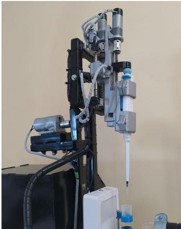
*Figura 72. Mecanismo de pipeteo y desplazamiento.*
