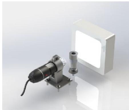
Figura 33. Subsistema de adquisición de imágenes.
