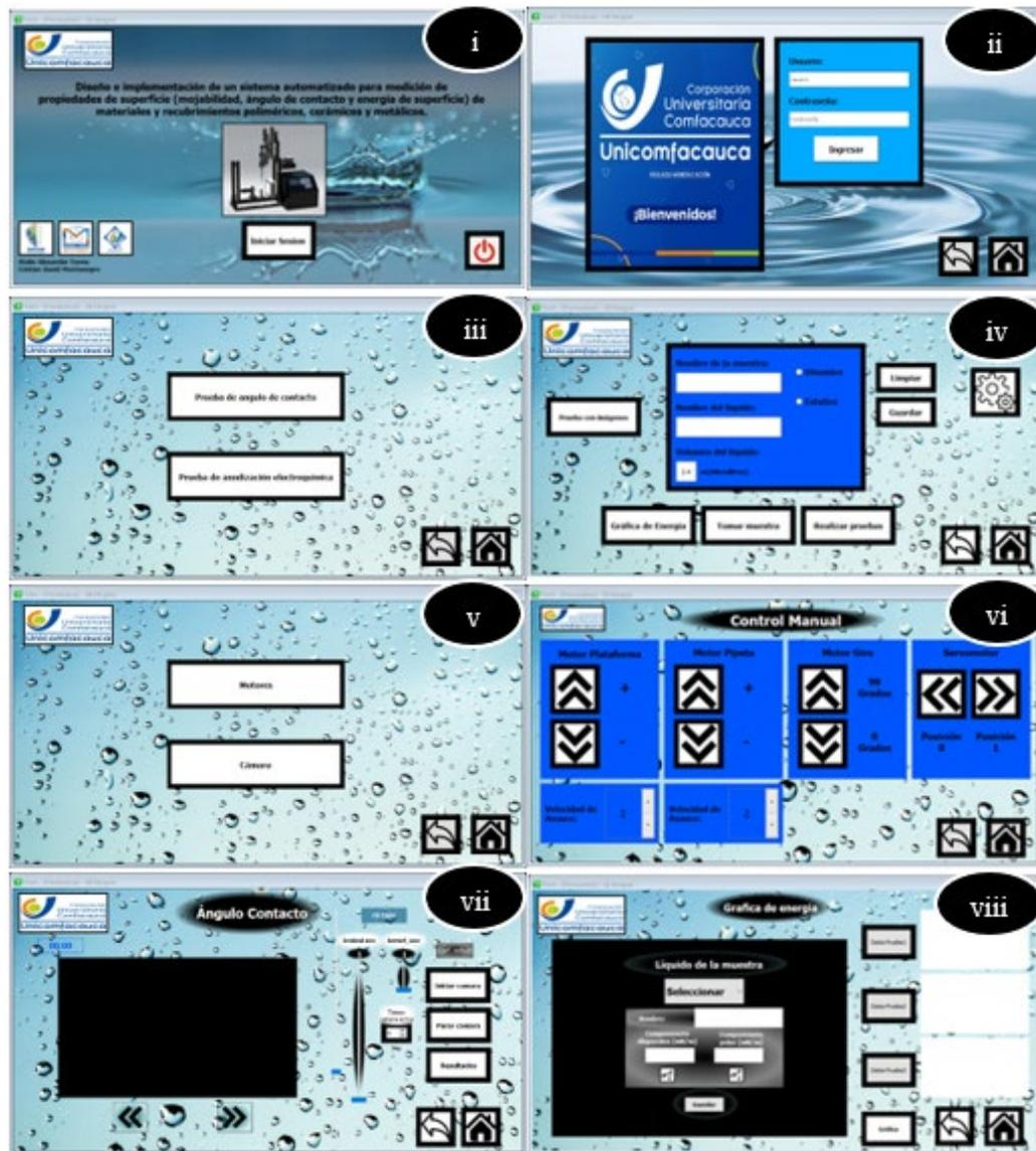
*Figura 78. Ventanas de la GUI en la HMI, (i) ventana principal, (ii) ventana de inicio de sesión, (iii) ventana para elegir el tipo de prueba, (iv) ventana para guardar datos, (v) ventana para elegir una de las dos configuraciones, (vi) ventana de configuración de motores, (vii) ventana de configuración de cámara y (viii) ventana para graficar.*
