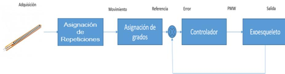
Figura 23. Esquema de control.
