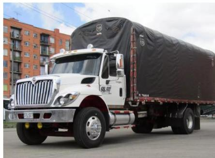
Figura 42. Vehículo configuración C2
