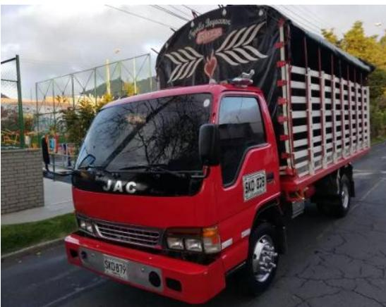
Figura 32. Vehículo con carrocería de estacas
